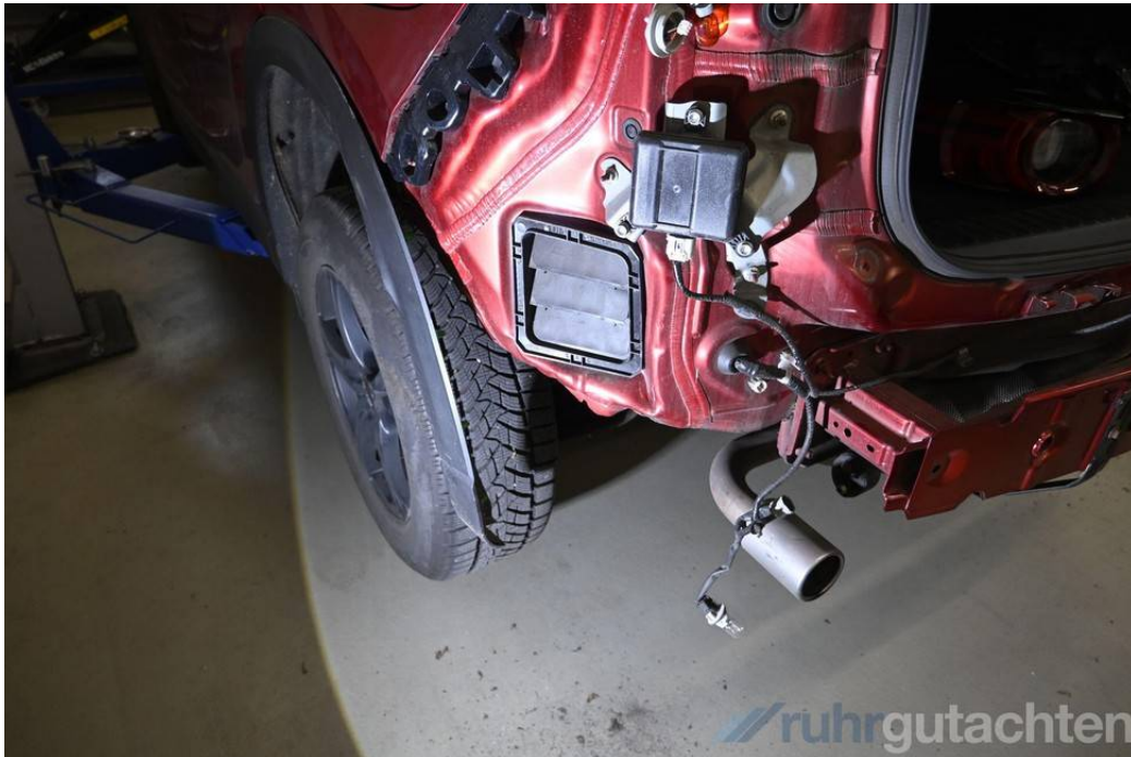
Nicht reparierter Vorschaden: Seitenwand hinten links unterhalb deformiert
