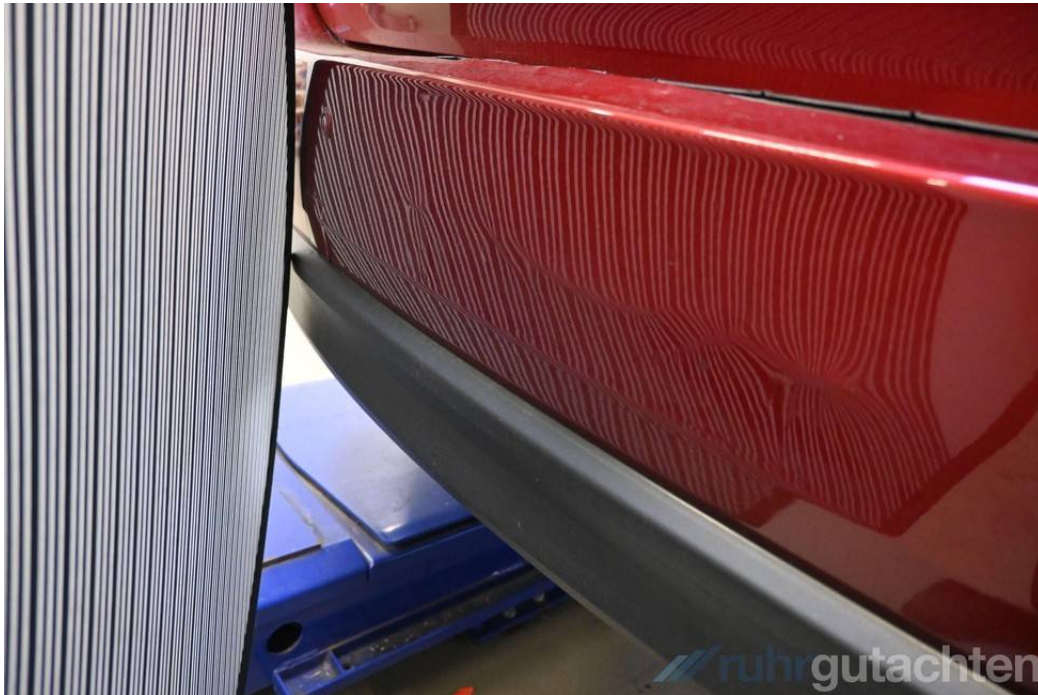
Heckverkleidung deformiert
