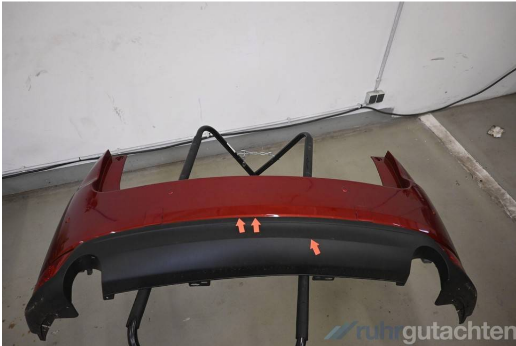
Heckverkleidung Unterteil kratzbeschädigt
