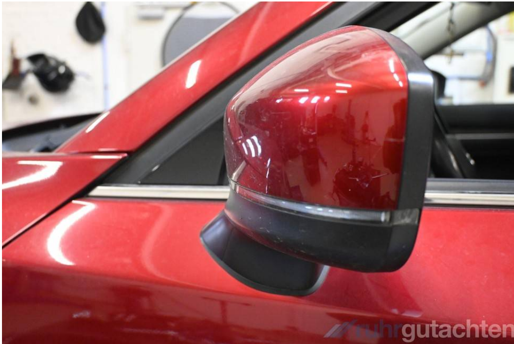
Nicht reparierter Vorschaden: Außenspiegelkappe links kratzbeschädigt
