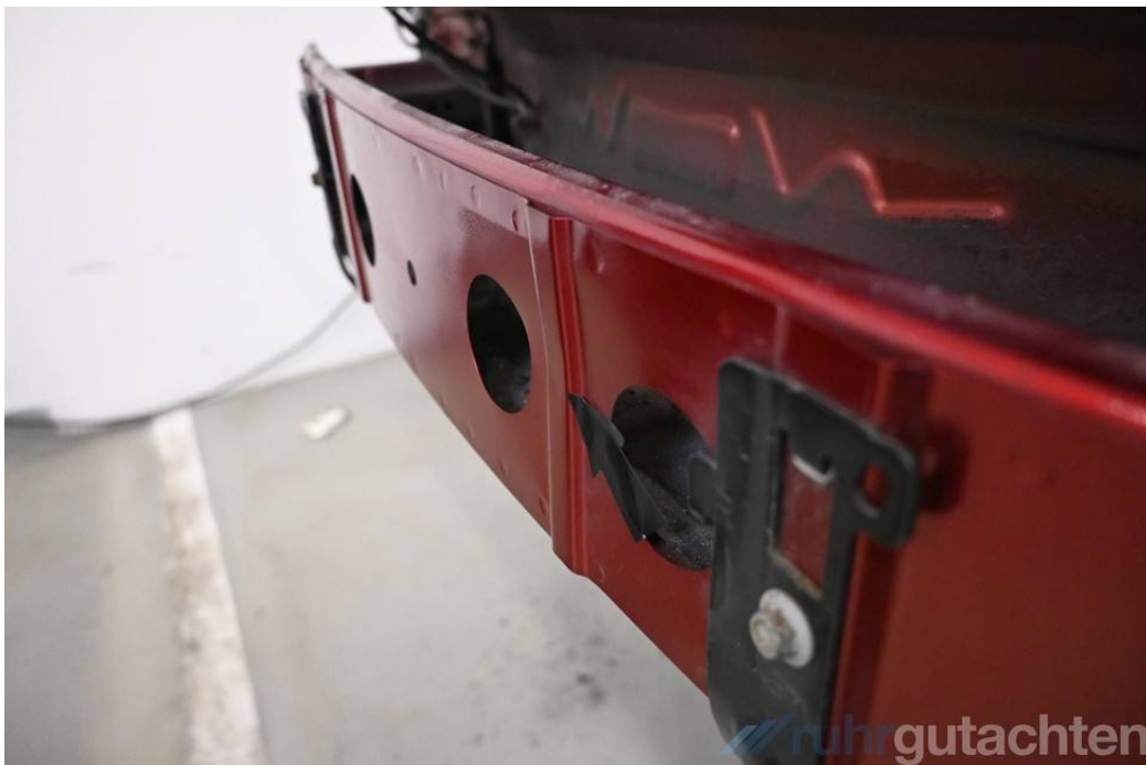
Querträger hinten deformiert
