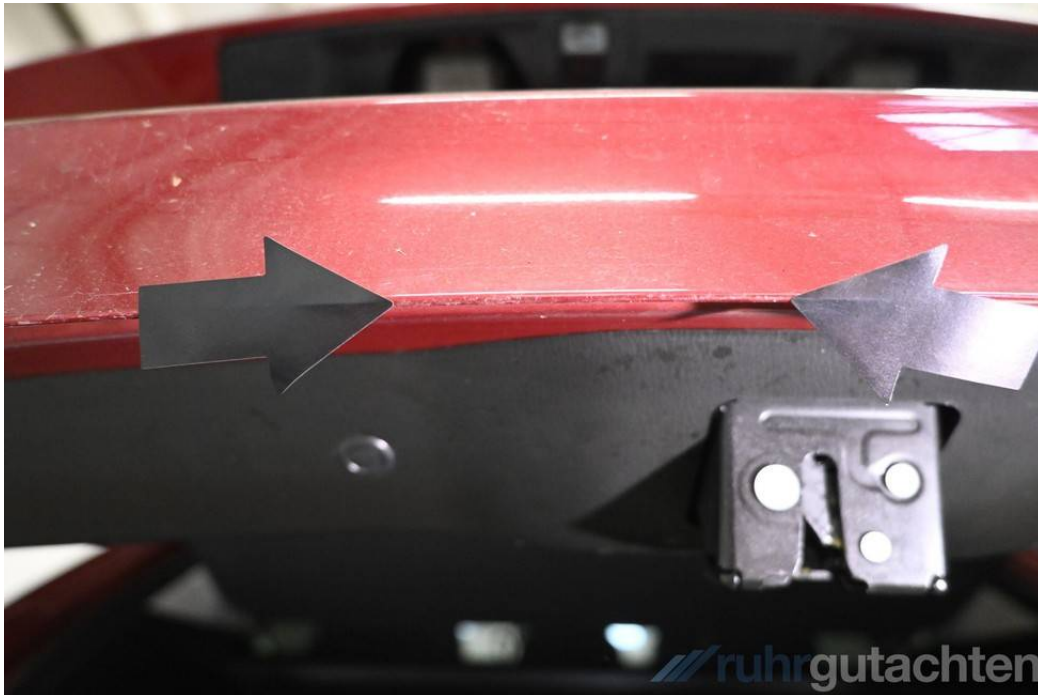
Heckklappe unterhalb kratzbeschädigt
