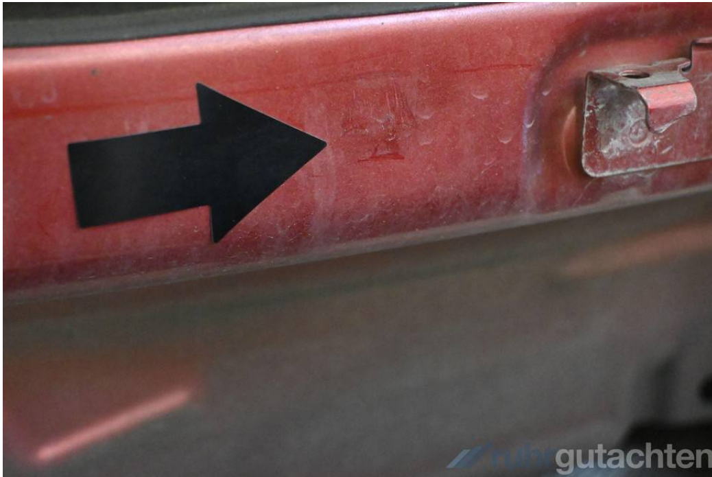
Heckabschlussblech verformt und kratzbeschädigt
