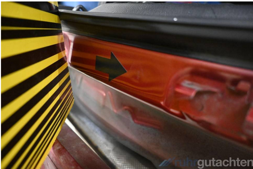
Heckabschlussblech verformt und kratzbeschädigt
