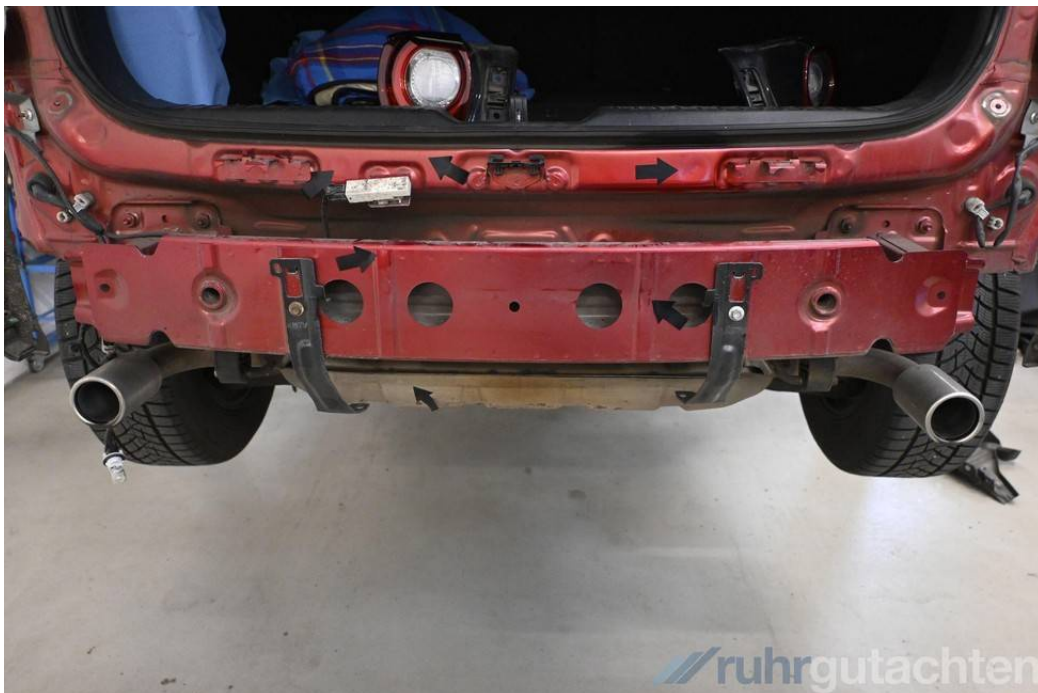
Querträger hinten deformiert
