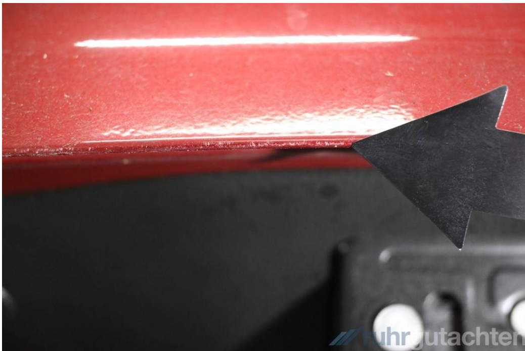
Heckklappe unterhalb kratzbeschädigt
