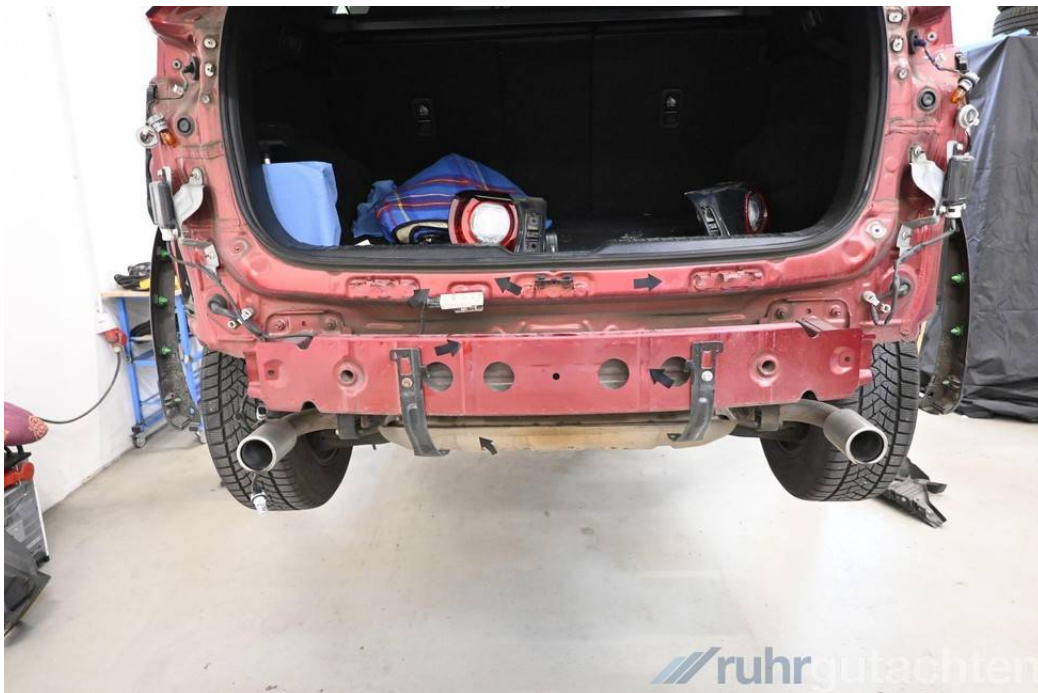
Heckabschlussblech verformt und kratzbeschädigt
