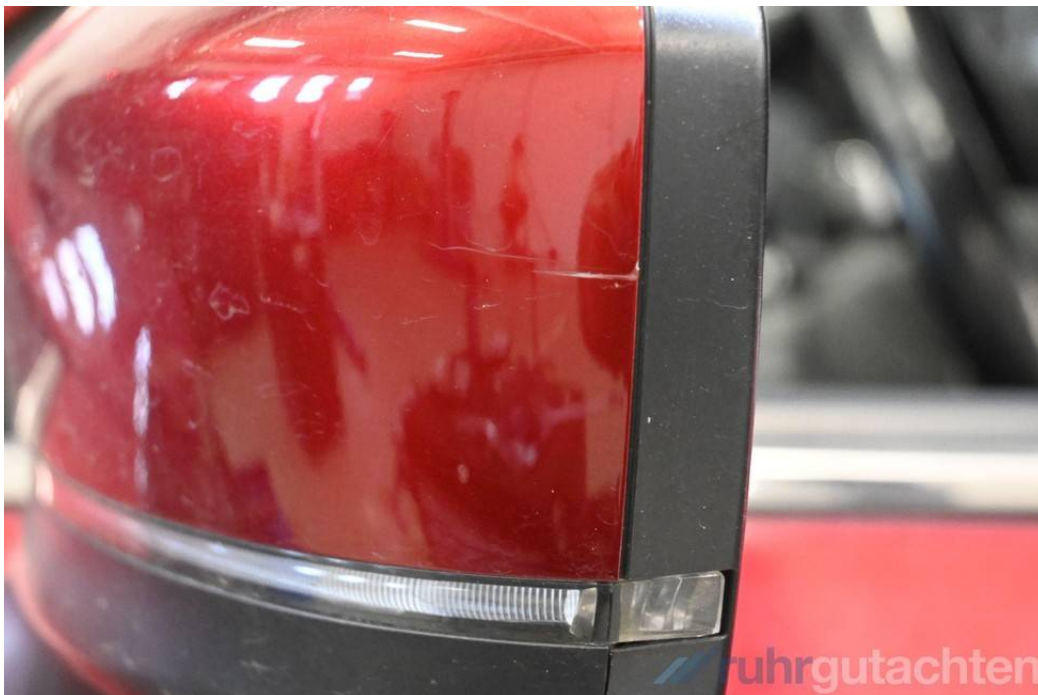
Nicht reparierter Vorschaden: Außenspiegelkappe links kratzbeschädigt
