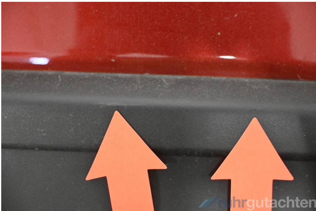
Heckverkleidung Unterteil kratzbeschädigt
