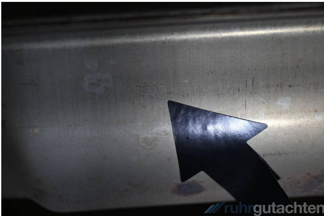
Endschalldämpfer kratzbeschädigt
