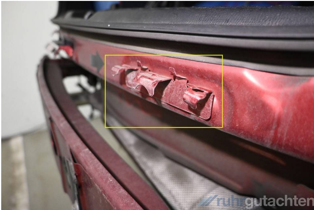
Heckabschlussblech verformt und kratzbeschädigt
