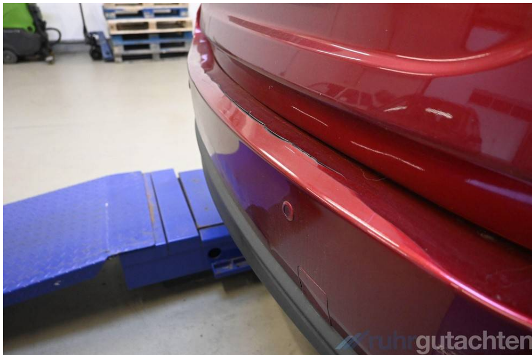
Heckverkleidung gebrochen
