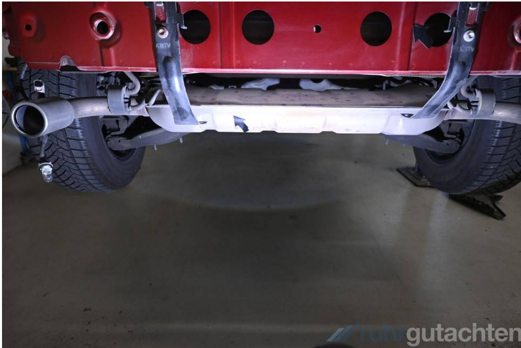
Endschalldämpfer kratzbeschädigt
