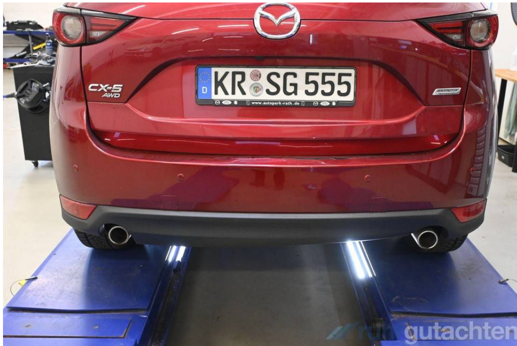
Heckverkleidung deformiert und gebrochen
